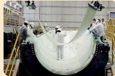
**3** Bolsa de vácuo com infusão de resina epóxi e processo químico de endurecimento (cura).
