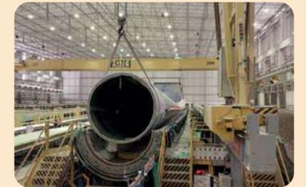
**6** Retirada da pá dos moldes e inspeção de qualidade através de Ultrassom.
