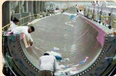
**2** Montagem do posicionamento da raiz e colocação do *sparcap*.
